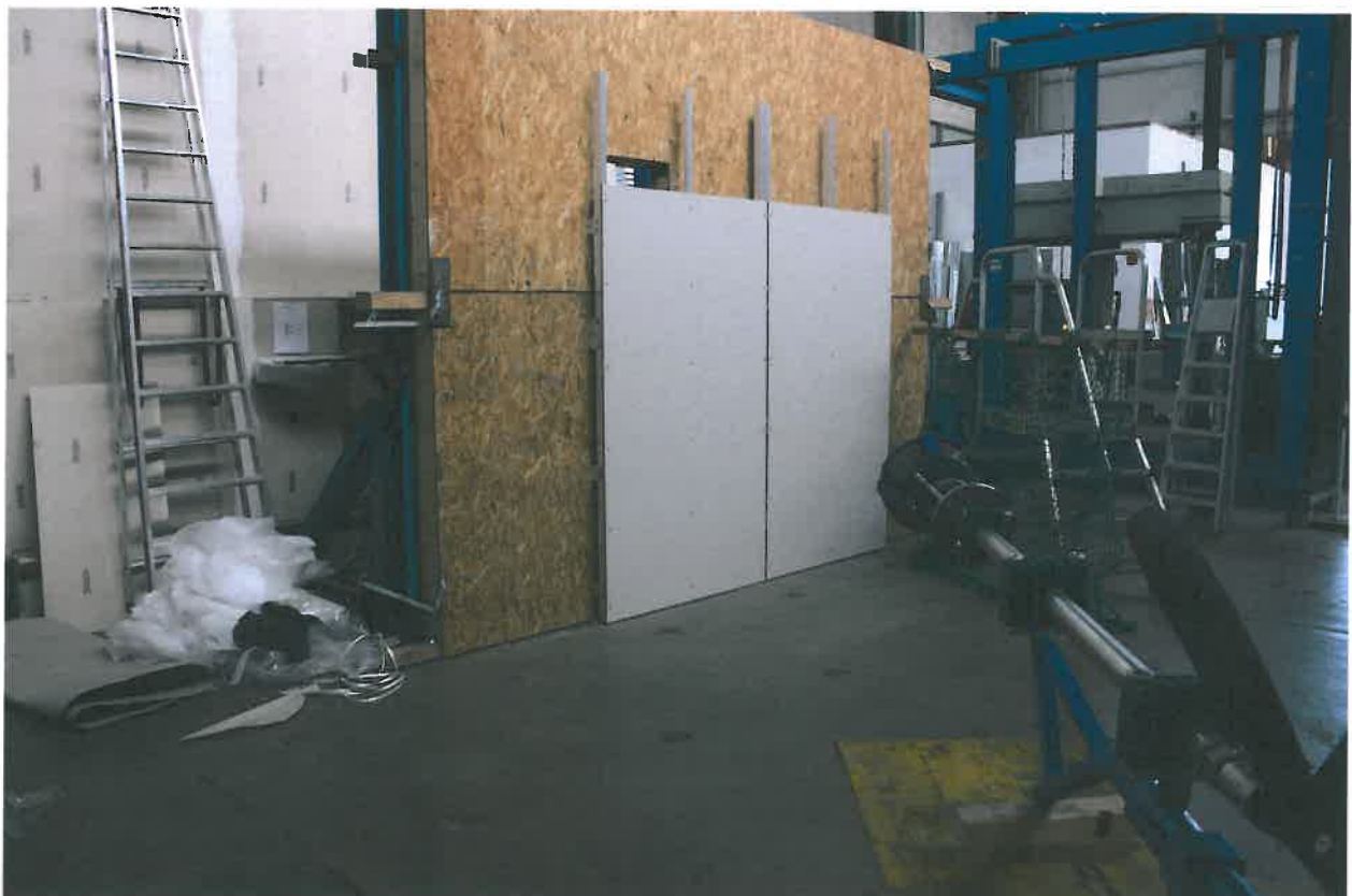
Abbildung 2: Ansicht des Prüfaufbaus und des Ballschussgerätes – Beschusswinkel 45°
